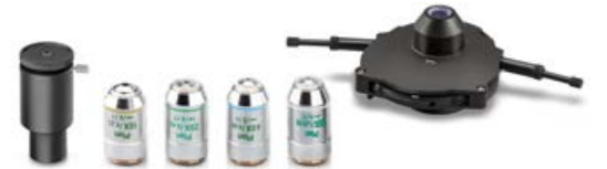
5-fach PH-Universal-Drehkondensator mit 10×/20×/40×/100× Infinity-PH-Plan-Objektiven (Komplett-Set)
