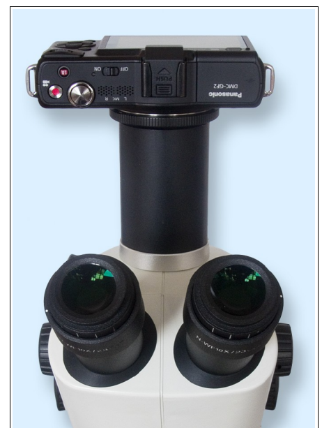
Bild rechts: Direktadapter für Micro Four Thirds und Nikon 1 am Mikroskop Motic SMZ171
