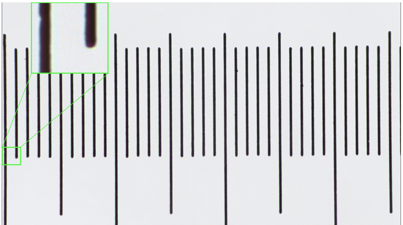
Objektmikrometer mit justierter und aktiver CVD-Kompensation – der Ausgleichsrand zeigt sich als feiner, schwarzer Rahmen
