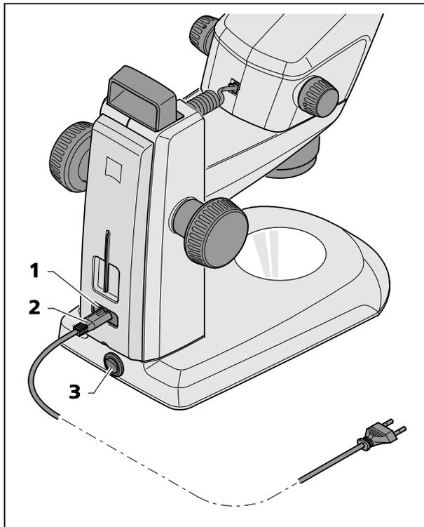
**Bild 17 Stereomikroskop anschließen**
