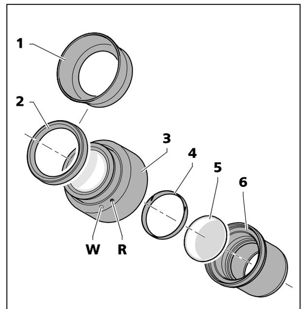
**Bild 16 Okularplatte einsetzen**
