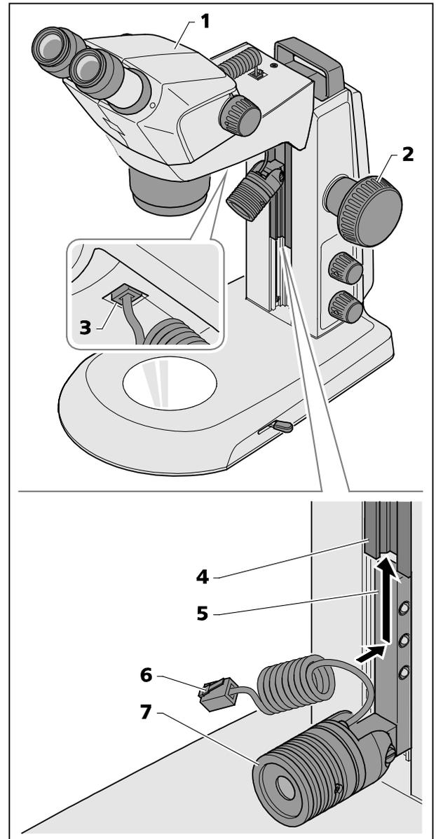
Bild 12 Spot-Leuchte montieren
