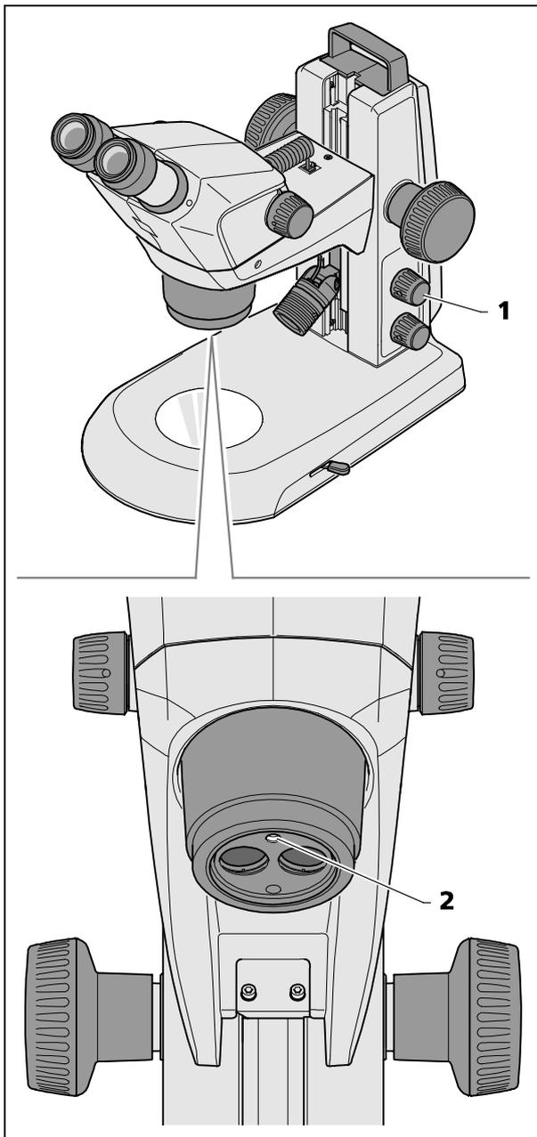
**Bild 20 Vertikalbeleuchtung einstellen**
