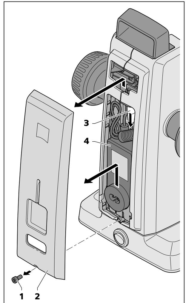
**Bild 27 Netzteil wechseln**
